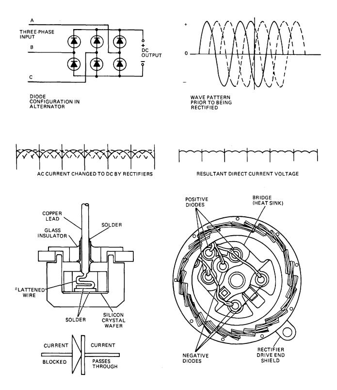
Figure 13-22. Diode Arrangement Rectifier Bridge.
